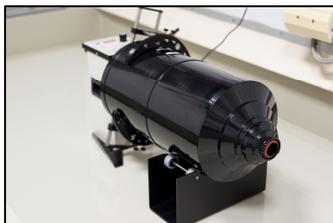
Diese Version ermöglicht die Entwicklung von 8x10 inch Planfilmen. Der Tank wird dauerhaft rotiert, jedoch nicht gekippt.
