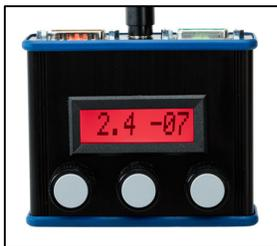
Das Bild links zeigt eine typische Einstellung zur Belichtung von Multigrade-Papier mit Gradation 2,4 und einer auf -0,7 Blenden reduzierten Helligkeit. Im Bild rechts ist ein Steuerkabel für eine klassische Schaltuhr gezeigt.
